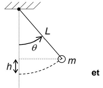
**51) La hauteur  $h$  entre la position du pendule (à un instant quelconque où il est écarté d'un angle  $\theta$  par rapport à la verticale) la position d'équilibre (voir schéma) est :**
